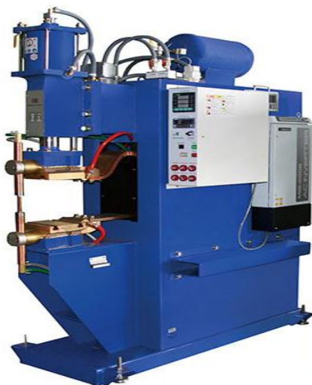
(ค) เครื่องเชื่อมจุดแบบติดตั้งประจำตำแหน่ง
