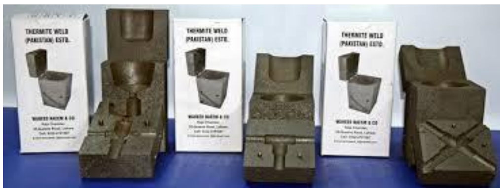
รูปที่ 4.94 ตัวอย่างแบบหล่อกราฟไฟต์ของการเชื่อมเทอร์มิตงานเชื่อมต่อทางไฟฟ้า
