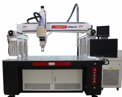
(ค) เครื่องเชื่อมเลเซอร์แบบ CNC (CNC welding machine)
