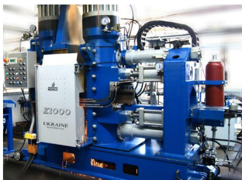
(ข) เครื่องเชื่อมวาวรางรถไฟแบบประจำที่ (Stationary flash weld rail way welding machine)
