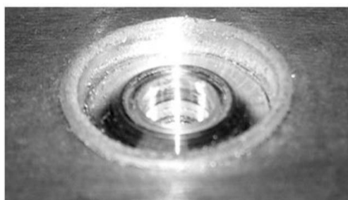
(ก) แนวเชื่อมของการเชื่อมแบบ FSSW
