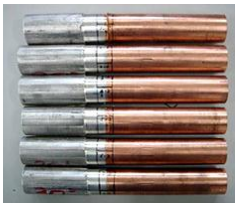
(ข) ตัวอย่างชิ้นงานโลหะที่ผ่านการเชื่อม
