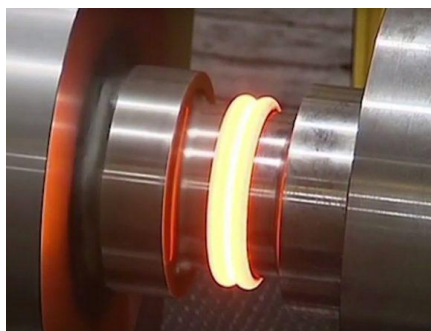
(ก) การไหลของเนื้อโลหะขณะเชื่อม
