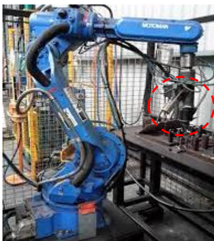
(ค) เครื่องเชื่อมสตั๊ดแบบระบบอัตโนมัติ
