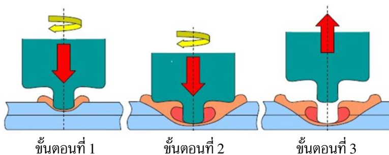
(ค) ขั้นตอนของการเชื่อมแบบ FSWW
