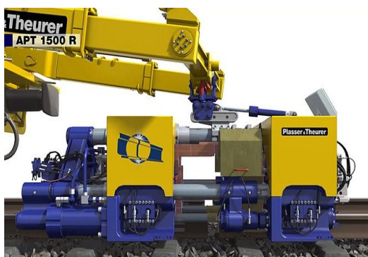
(ก) เครื่องเชื่อมวาวรางรถไฟแบบเคลื่อนที่ (Mobile flash weld railway welding machine)
