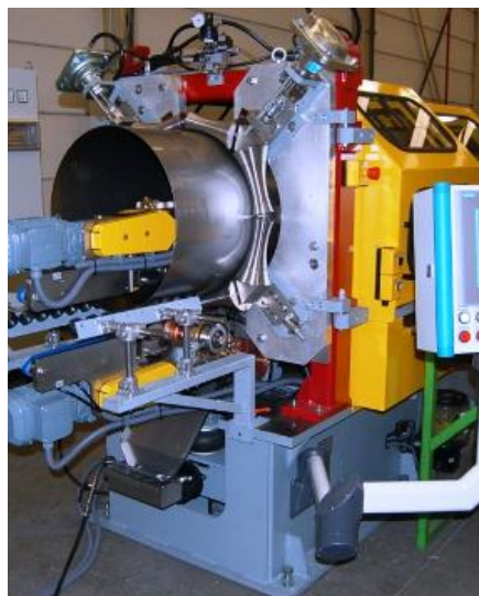
(ข) เครื่องเชื่อมตะเข็บด้วยระบบควบคุม อัตโนมัติ (Automatic seam welding machine)
