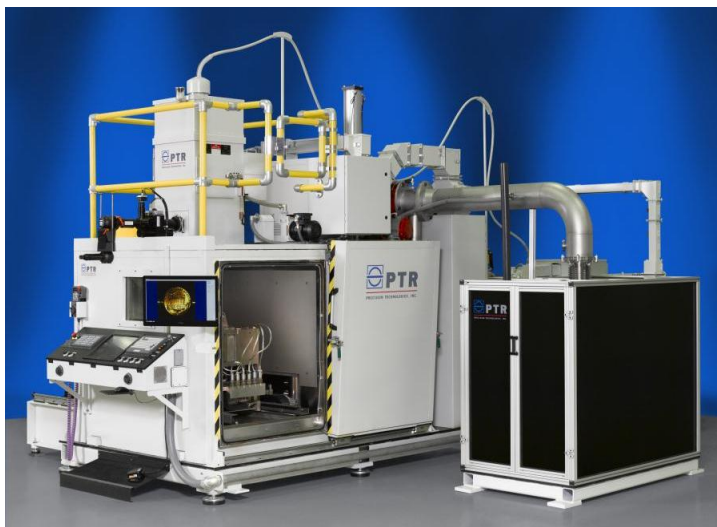
รูปที่ 4.110 ชุดระบบ เครื่องเชื่อมลำแสง อิเล็กตรอน (EBM) ที่มา : PTR Precision Technologies : Electron beam welding system, 2008
