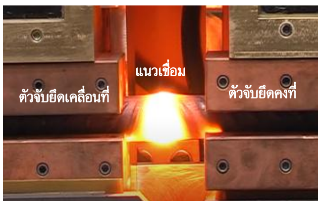
รูปที่ 4.56 กรรมวิธีการเชื่อมด้วยความต้านทาน (Resistance upset welding)
