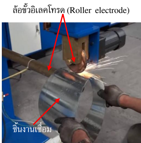
(ก) การเชื่อมตะเข็บโลหะแผ่นบาง
