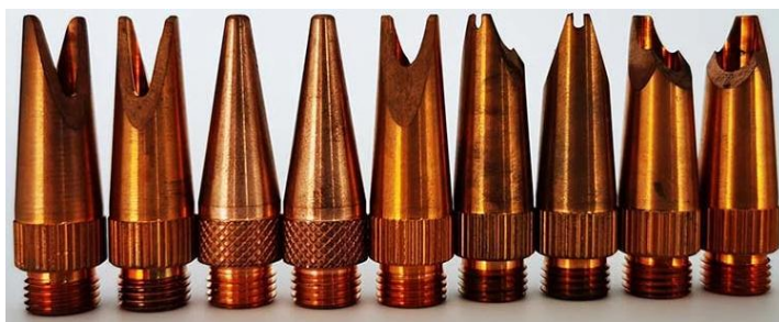
(ค) หัวฉีดของหัวเชื่อมเลเซอร์ (Nozzle)
