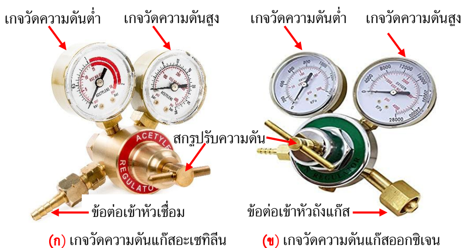
รูปที่ 4.4 เกจวัดความดันของแก๊สอะเซทิลีนกับแก๊สออกซิเจน
